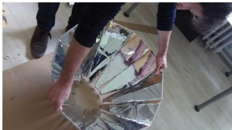
A l'aide d'un petit clou, percez le bout de chaque lamelle en la superposant avec le disque de carton. Unir les deux morceaux de carton à l'aide d'une cordelette. Répétez cette opération pour les 11 autres lamelles.
