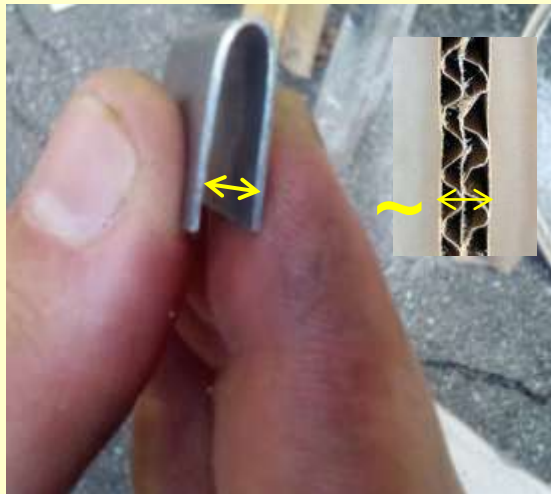
4/ Terminer le pliage en rapprochant les 2 extrémités de la plaque (conserver un espace proche de l'épaisseur du carton des facettes)
