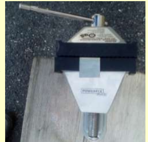
3/ Amorcer un pliage de la plaque à 90° selon ce trait à l'aide d'un étau
