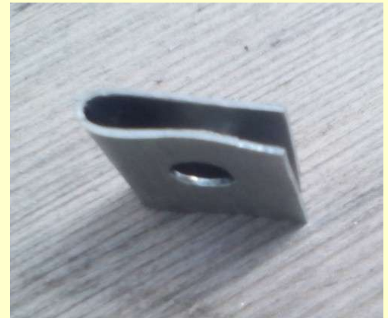
3/ Amorcer un pliage de la plaque à 90° selon ce trait à l'aide d'un étau
