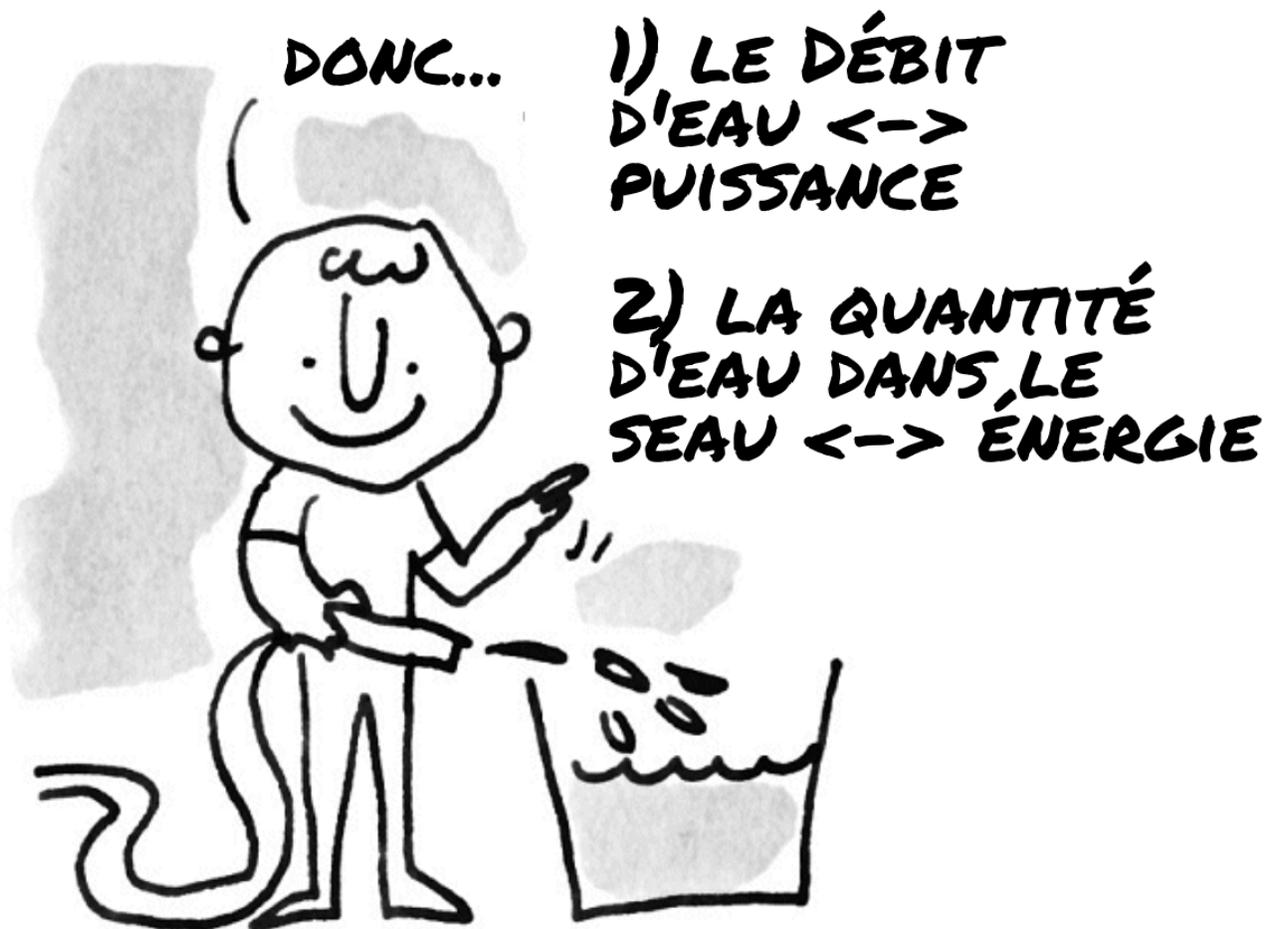
Figure 1.3 L'analogie eau/électricité.
