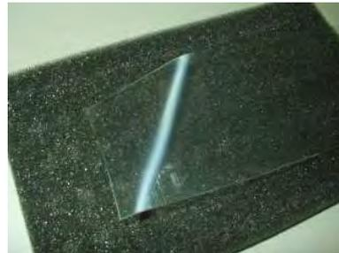
1. Le type 1: il se travaille à basse température (120°C) mais présentent ces inconvénients: si la température dépasse les 120°C alors il blanchit et c'est foutu! de plus il n est pas très élastique, et il a fallu que je m'y reprenne plusieurs fois pour ma verrière de CAP :(
