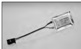
RX-Kondensator 22.000 uF, condensateur No. F1622
