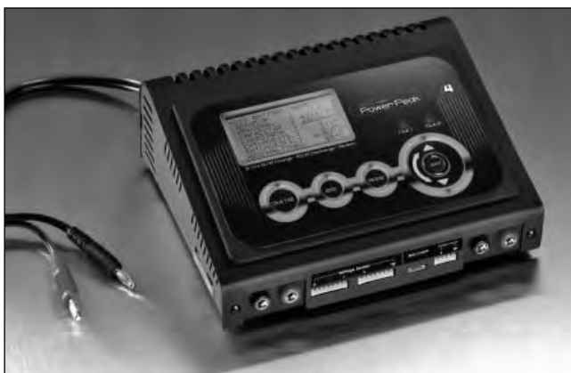
Power Peak I4 EQ-BID No. 8507 Station de charge intelligente de la 4ème génération pour charger/décharger les accus NC, NIMH, plomb, Life, LiLo et LiPo. Equalizer intégré et système de touche sensitive Cap Touch.
