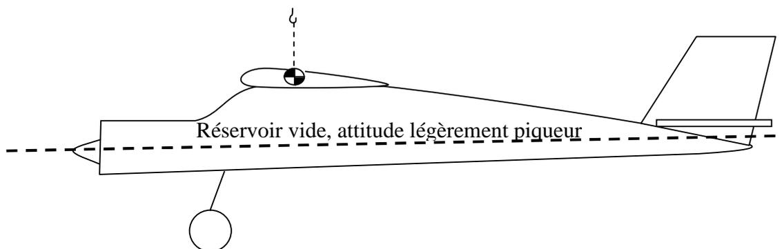
Théoriquement, si le choix du matériel préconisé par le concepteur du modèle est respecté, la position de chaque élément sera conforme à celle du plan. Et le centrage sera satisfaisant. Dans le cas contraire, à ce stade de la construction, il n'y a que le positionnement du matériel radio ou l'ajout de poids qui puisse être utilisé pour obtenir ce centrage.
