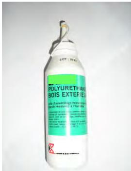
Cette colle est expansive et pénètre dans les moindres interstices lors du séchage. Afin d'éviter une déformation des pièces par repoussage par le film de colle, ou un bouchage des zones libres adjacentes au collage, il est nécessaire de bien doser la quantité de colle et de maintenir l'assemblage sous presse. Les excès de colle tâchent et s'éliminent difficilement. Malgré son apparence, la résistance au ponçage de cette colle est supérieure à celle des bois tendres (balsa, samba .. .)
